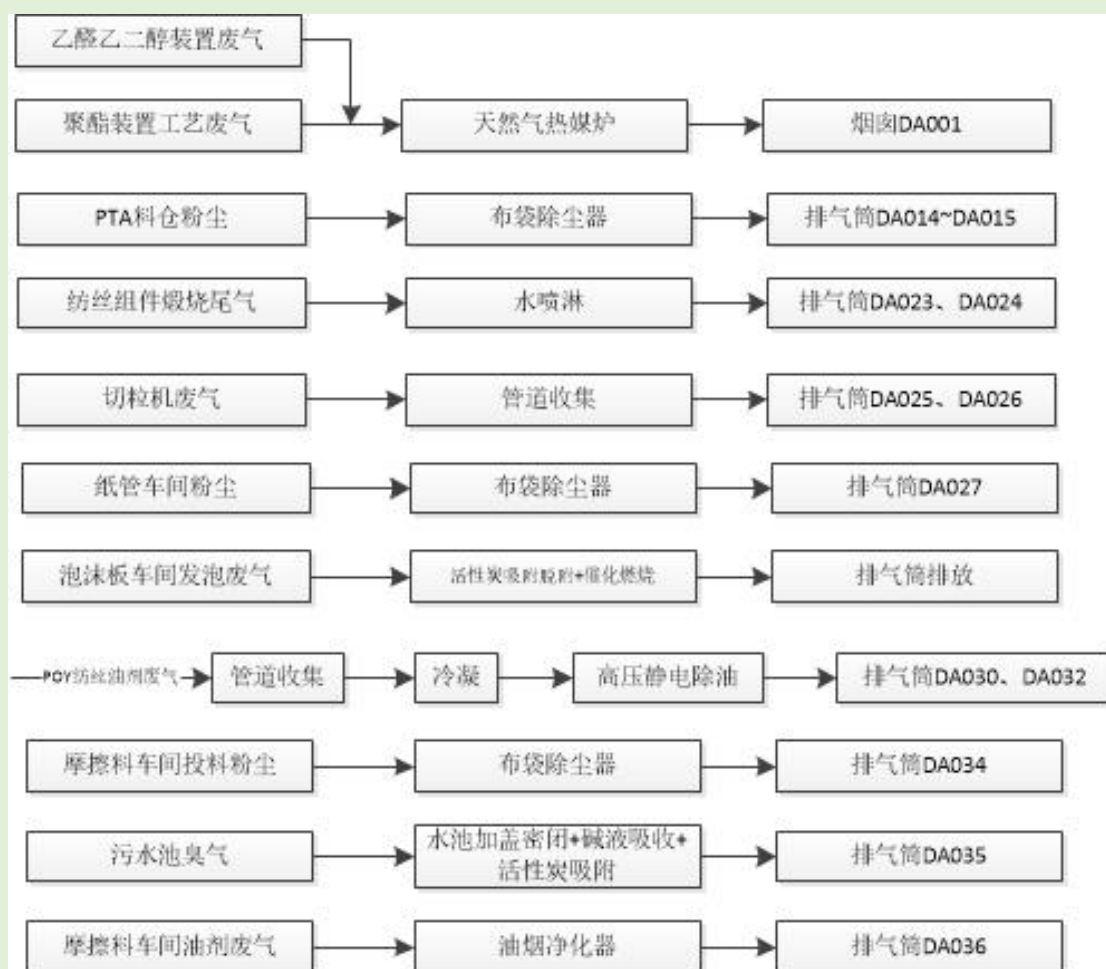
图 3.2-10 POY 厂区废气排放路线
